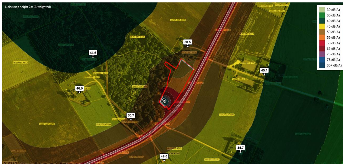
Joonis 6 Mürä hajumise pilt, kus arvestatud süvendiga, lähimate elamute suunal võimalusel rajatavate müratõkkevallidega ja masinate paiknemisega ala lõunaosas
