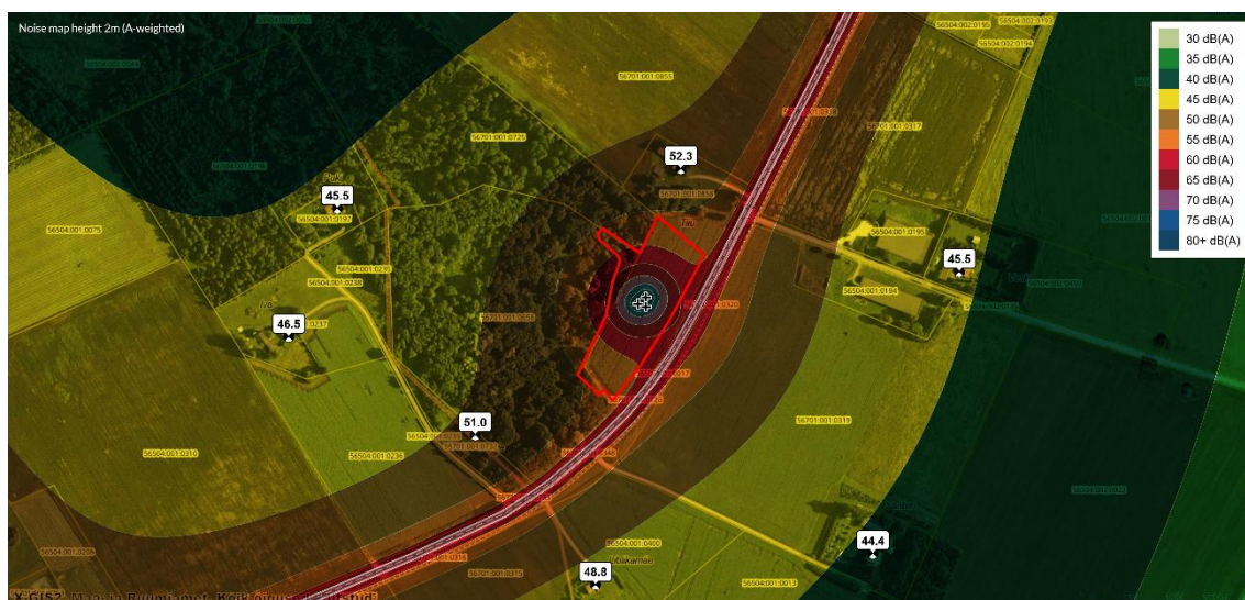
Joonis 2 Mūra hajumise pilt, kus arvestatud süvendiga ja masinate paiknemisega ala keskel
