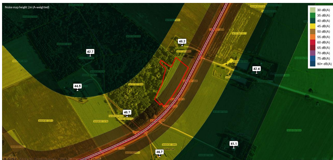
Joonis 1 Mūra hajumise pilt täna ehk enne kaevandamisega alustamist
