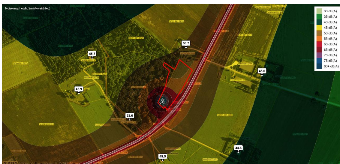
Joonis 3 Mūra hajumise pilt, kus arvestatud süvendiga ja masinate paiknemisega lõunaosas
